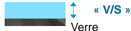
**Altération en système Fermé : Paramètre clef : le rapport V/S**
