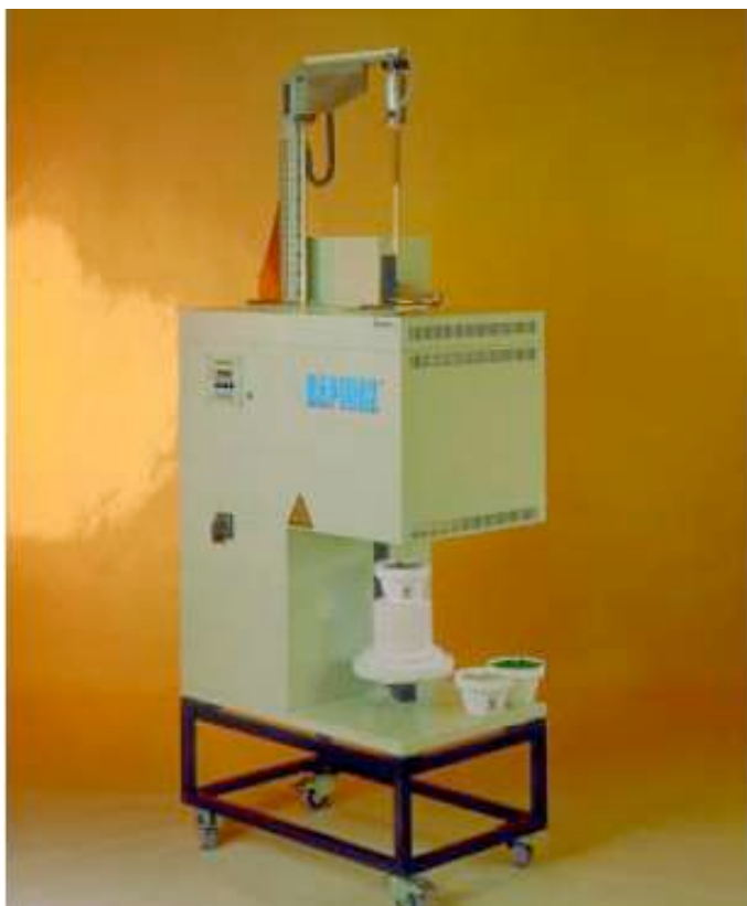
Le four Rapidox® (société Heraeus) pour la mesure de la pression d'oxygène dans les verres fondus
