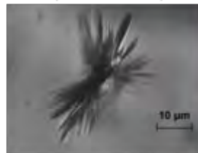
Silice 7980, 5 J/cm 2 , 351 nm, 2.5ns (faisceau collimaté)
