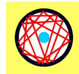
LA géométrie de la fibre est étudiée pour maximiser le recouvrement pompe-coeur dopé
