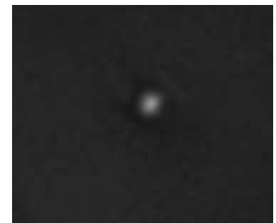
Image en champ proche de la sortie de fibre (fenêtre 7-13 µm)
