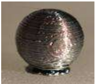
Réalisation de préforme pour moulage de lentilles 'free-fom'
