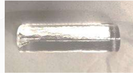
ZBLAN préforme ( \varnothing 18mm)
