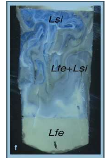
Photo de l'échantillon de verre C-112 trempé après 4 h de centrifugation à 1090 °C
