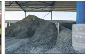
Le calcin : le produit fini, débarrassé de ses impuretés, est prêt à être fondu.
