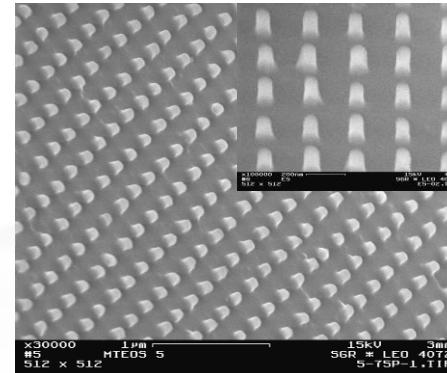
dots ( $\varnothing=75\text{nm}$ ,  $p=230\text{nm}$ ,  $h=150\text{nm}$ )
