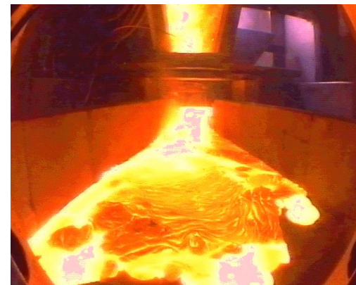
Étalement de corium liquide sur un substrat.
