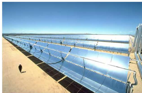
CS Parabolique \eta \approx 10-15\%
