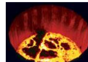
Four de vitrification par creuset froid (source CEA)
