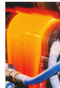
Coulée de vitrifiat en sortie de four (Source Europlasma)
