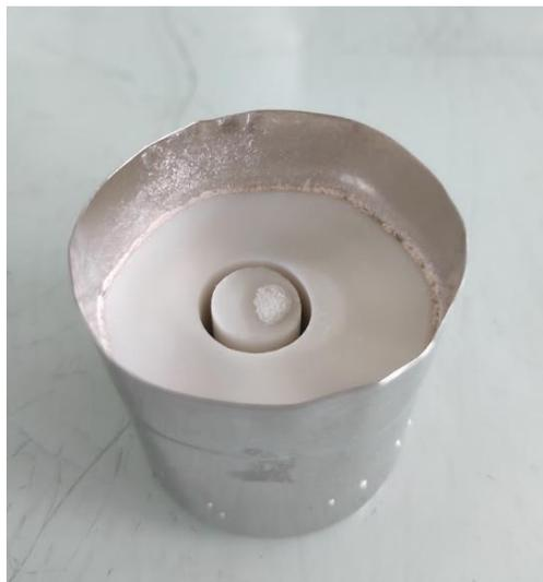
Figure 70 - Creuset de l'échantillon SBN-M5 *post mortem* présentant une séparation de phase secondaire. Une légère forme de bol est visible vers le milieu de la surface, avec une matière blanche poudreuse qui correspond à la phase macroscopique.
