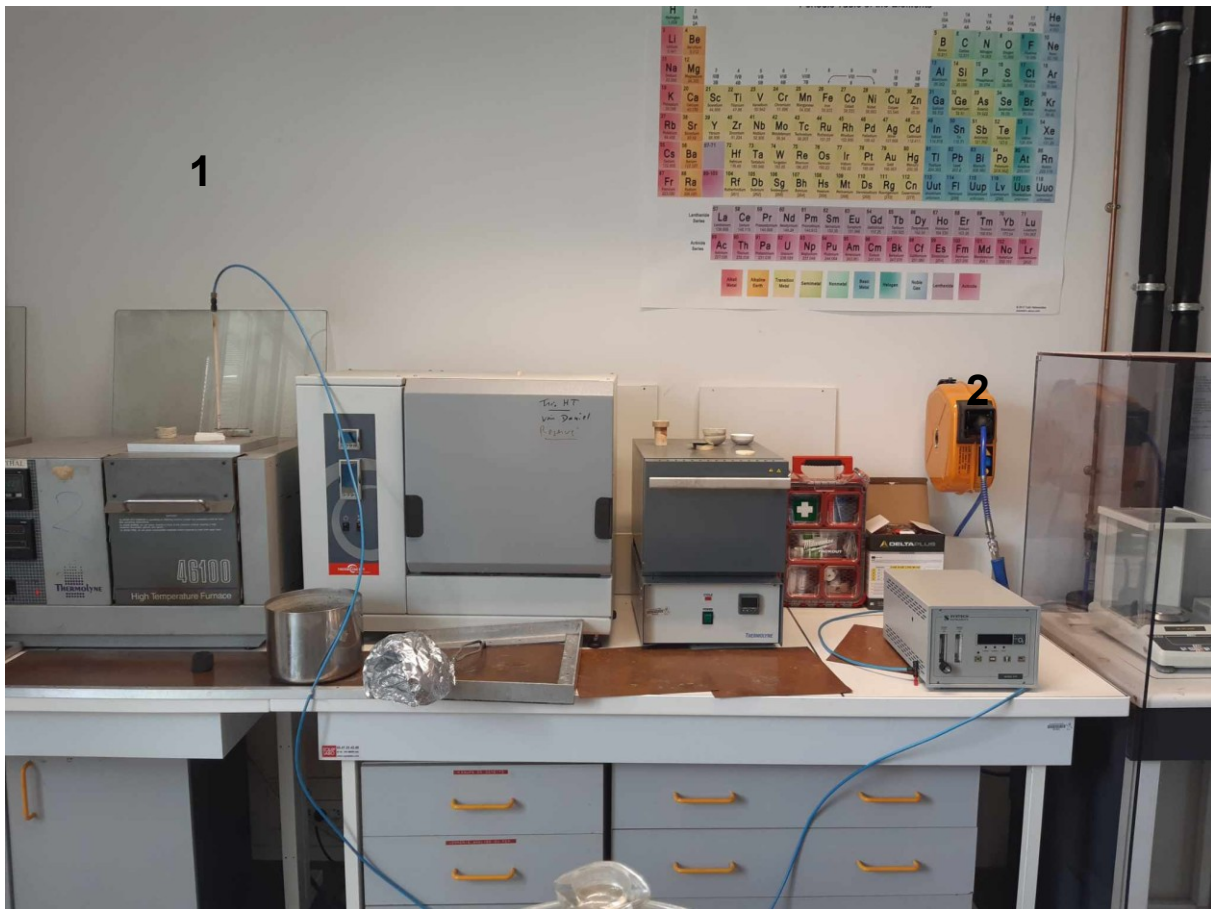
Figure A.1 : Image du dispositif de mesure de la fugacité d'oxygène. 1 : prise d'air dans le four. 2 : Appareil de mesure ZR800 de systech instruments
