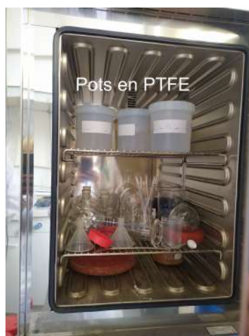
FIGURE 2.4 : Photo du dispositif de vieillissement en milieu immergé à 80 °C (pot en PTFE dans une étuve). ©A. Piccolo
