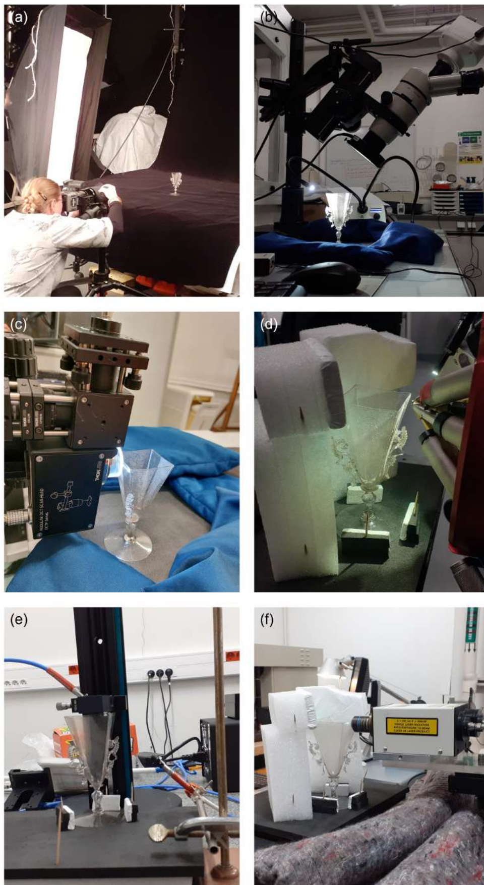
FIGURE 2.18 : Caractérisations non invasives du verre OA 1066. (a) Photographie UV-visible. (b) Microscope binoculaire. (c) Analyse par OCT. (d) Analyse élémentaire en PIXE/PIGE avec AGLAE. (e) Analyse en NIR. (f) Analyse par Raman portable. ©T. Law.
