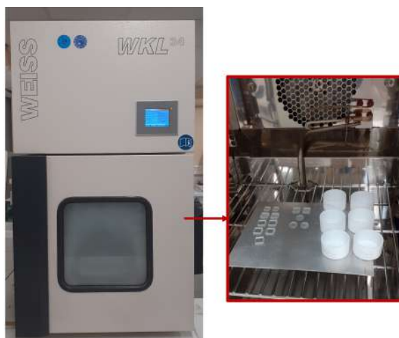
FIGURE 2.2 : Photo du dispositif de vieillissement à 80 °C et 80% HR (enceinte climatique). ©T. LAw.
