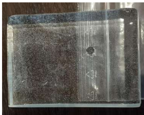
FIGURE 1.1 : Bloc de verre fabriqué par SGR (composition R = 0,6 qui présente des bulles dans la masse)
